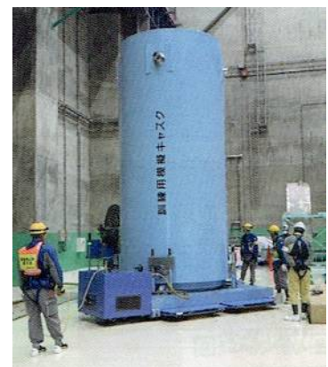
むつ施設の訓練用使用済み核燃料キャスクです。
