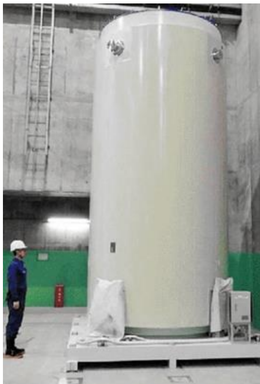
建屋内の貯蔵区域に設置された使用済み核燃料金属キャスク
